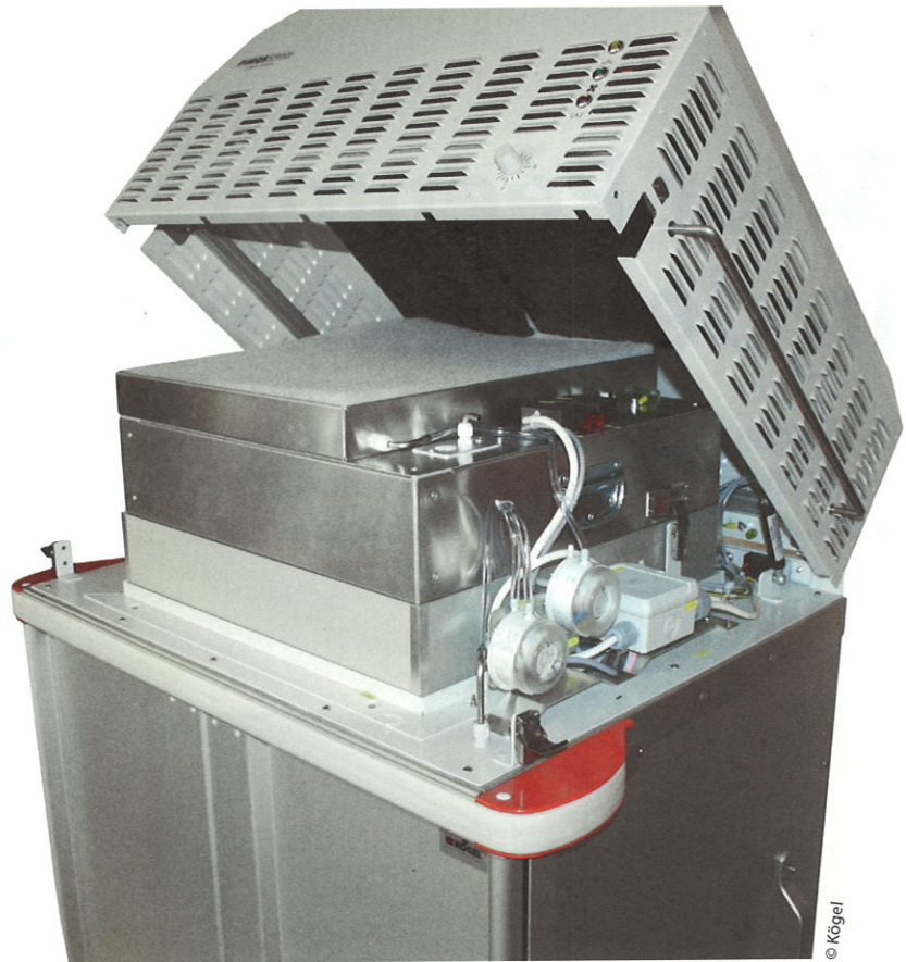
Die Abdeckhaube ist mit einer Filter-Ventilator-Einheit und einer Steuerungseinheit ausgestattet, um die Versorgung mit Reinstluft zu sichern.
