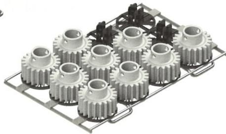
Mit einem flexiblen Inlay und den Kunststoff-Aufnahmedornen werden die großen Komponenten sicher im Reinigungskorb fixiert.
