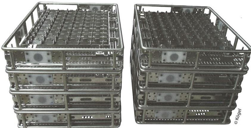
**Bild 3** > Mittels RFID-Chips, die sich problemlos in die Warenträger integrieren lassen, kann eine Vielzahl von Daten berührungslos abgelegt sowie in Sekundenschnelle erfasst und ausgelesen werden – auch ohne Sichtverbindung und über mehrere Meter Entfernung.
