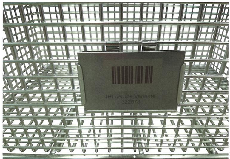
**Bild 1** > Mit einer angeklebten Datamatrix (links) oder einem eingeklipptem Barcodeschild (rechts) wird der Reinigungskorb zum Bindeglied in der Fertigungssteuerung.
