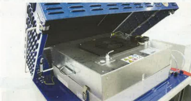
Die Abdeckhaube des PUROS Science ist mit einer Filter-Ventilator-Einheit und Steuerungseinheit zur Versorgung mit Reinstluft ausgestattet. Bild: Kögel
