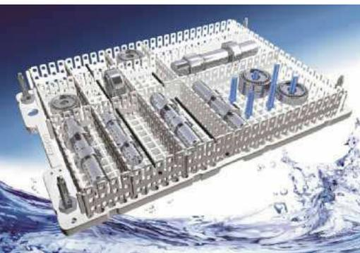
Kunststoff. Auf diesem können mit einem Rastermaß von 10 mm x 10 mm Gefacheteiler angebracht werden, mit denen sich der Werkstückträger an die Größe der zu reinigenden Bauteile anpassen lässt. Für die genauere Positionierung der Bauteile stehen Pins aus Kunststoff oder Metall zur Verfügung, die über ein Stecksystem oder einen Bajo-
