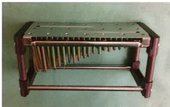
Abbildung 1: Eine geringe Perforation verhindert die optimale Umspülung der Schraubenköpfe
