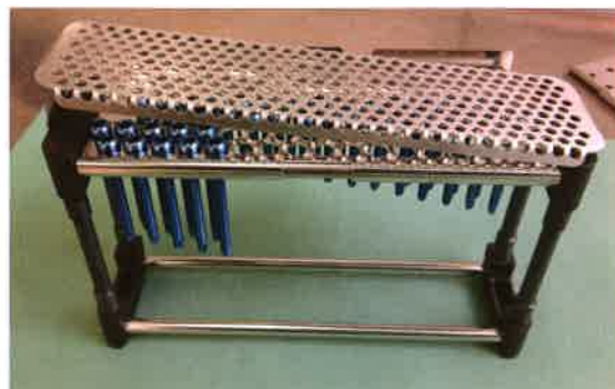
Abbildung 2: Perforierte Deckel können günstig nachgerüstet werden
