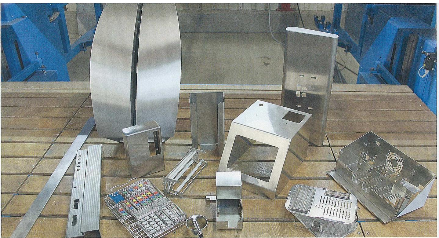
Eine Auswahl an für Kögel GmbH typischen freigeformten und bandgeschliffenen Werkstücken aus Edelstahlblech und Blech-/Draht-Kombinationen
