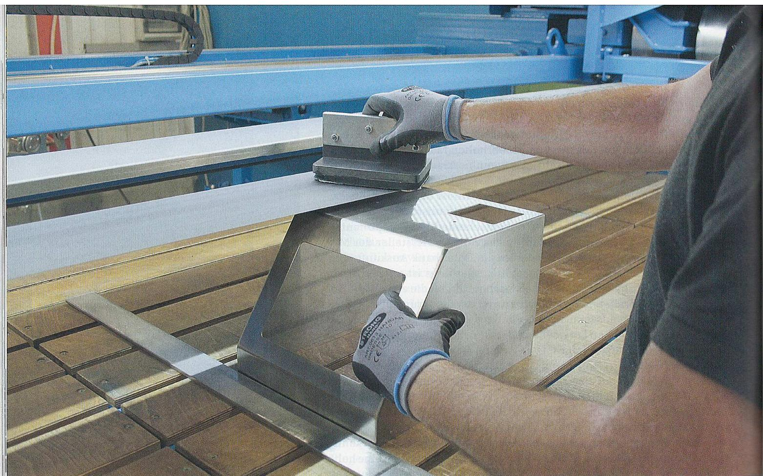
Die Maschine lässt sich sowohl zum rationellen manuellen Schleiffinish einsetzen – hier an einem Gehäuse aus Edelstahlblech – als auch zum Schleifen von Blechteilen, die mit verschiedenen Zusatzeinrichtungen fixiert werden. Bilder: Tritschler
