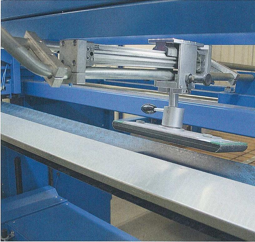
Die pneumatisch betriebene Wechsellvorrichtung zum automatischen Verschieben des Schleifschuhs auf das jeweils benötigte Schleifband
