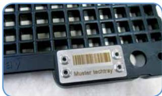
Mit den techtray™- Werkstückträgerkennzeichnungen ist das System bestens für den Einsatz in einer automatisierten Umgebung und für logistische Abläufe vorbereitet.
