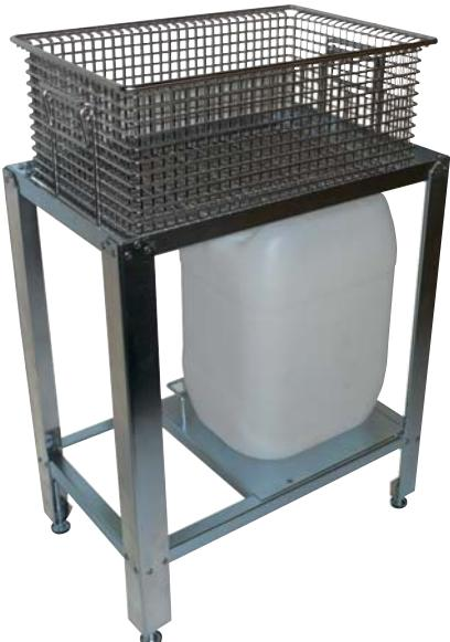
**Abtropftisch** aus Stahl, galvanisch verzinkt zum universellen Aufstellen direkt am Arbeitsplatz. In die Wanne können Reinigungskörbe lose eingestellt werden. Das Tropfgut wird über den Ablaufstutzen abgeführt und in einem Behälter gesammelt. Dadurch minimierte Verschleppung von KSS oder Öl beim Transport der Körbe. Das KSS/Öl kann dem Kreislauf wieder zugeführt werden. Mit Höhenausgleich im Bodenbereich oder zur Schrägstellung des Tisches.
