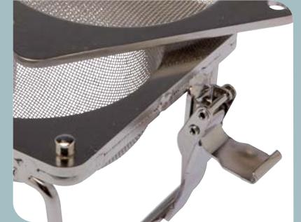
Um Kleinteile > 2 mm sauber reinigen und handeln zu können, wurde der SGK-KT (Schüttgutkorb-Kleinteile) entwickelt. Durch die Halbkugelform ist eine optimale Zugänglichkeit für Reinigungsmedien gegeben. Die Deckelkulisse schliesst den Korb flächig ab. Durch die tiefgezogene Gewebeform lassen sich die Werkstücke somit vereinzelt per Hand entnehmen. Camloc-Verschlüsse verbinden Korb und Deckel.
