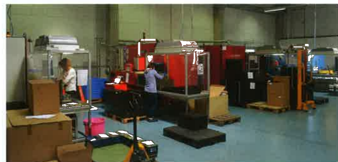
Mit insgesamt sechs Anlagen reinigt das Unternehmen Dreh-, Fräs-, Stanz-, Press-, Druckguss- und Drahtbiegeteile für die Automobilindustrie und den Maschinenbau.
