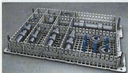
Das neue Werkstückträgersystem basiert auf einem Gitterboden aus temperaturbeständigem Kunststoff
